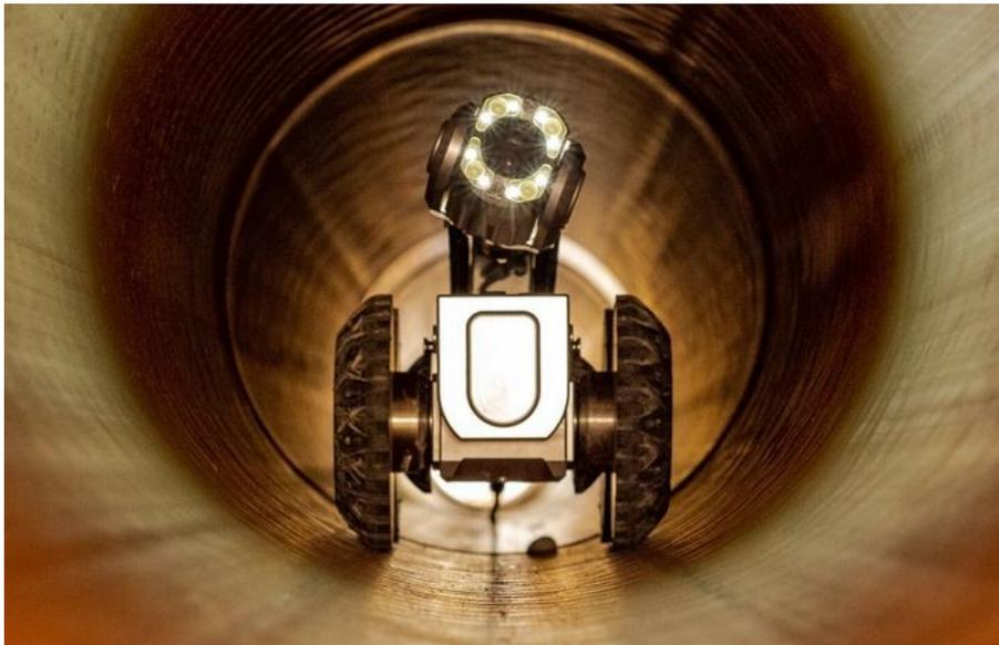
Abbildung 4: Beispiel einer Kamera im Kanal, Quelle: IPEK.AT
