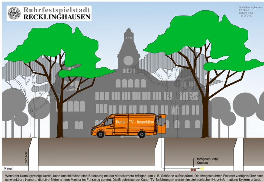
Abbildung 3: Prinzip der ferngesteuerten TV-Roboter-Technik, Quelle: Stadtverwaltung Recklinghausen
